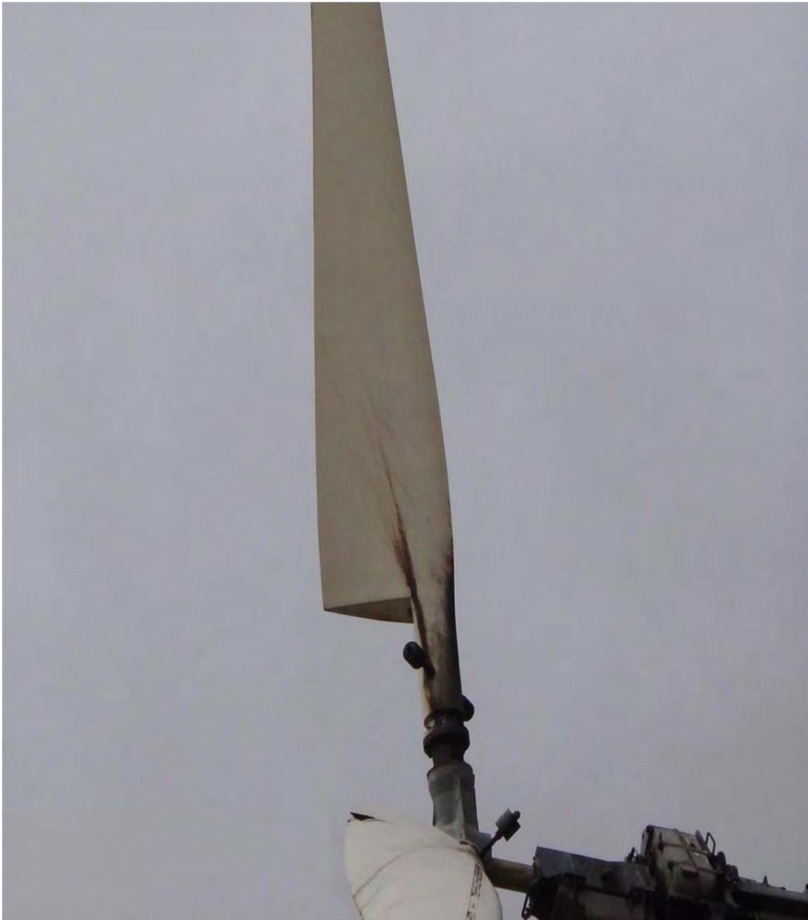
**FIGURE 4**      **CLOSE-UP VIEW OF RUST STAINING EMANATING FROM WIND TURBINE IFD ROD**
